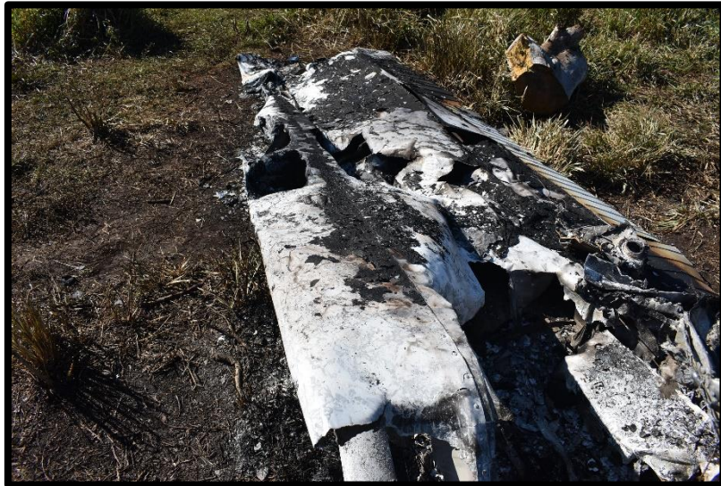
Fotografía No. 10 Vista de la sección superior del ala derecha.
