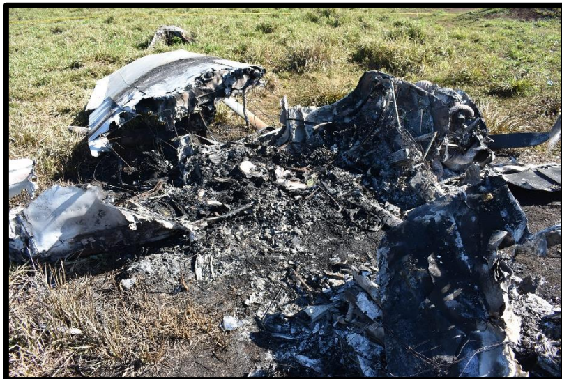
Fotografía No. 4 Fuselaje consumido por el fuego.
